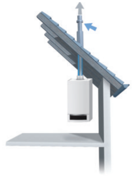
Raumluftunabhängige Aufstellvariante mit Abgasleitung über Dachinstallation
