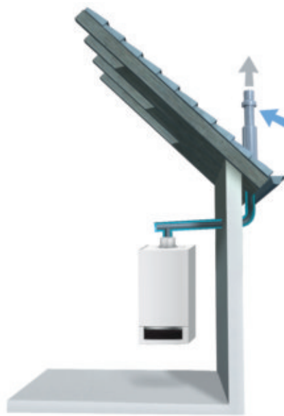
Raumluftunabhängige Aufstellvariante mit Rohr-in-Rohr-Kunststoff-Abgassystem (Außenfassade)
